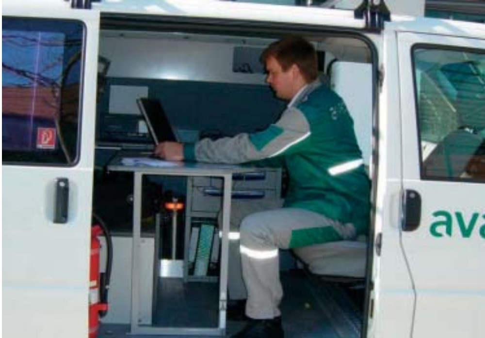
Büroarbeitsplatz im Netzmonteurfahrzeug mit Drehsitzvariante und Laptop
